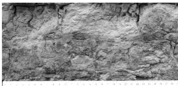
**Figure 3. Brique crue: longueur 28 cm - largeur 13,5 cm - épaisseur 6 cm.**
