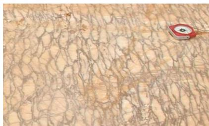
**Photo 6.** Graphisme suivant le sciage horizontal : variété en "poissons".
