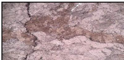
**Photo1.** Aspect du marbre de Bou-Acila en lame mince orientée montrant les directions principales de la fracturation.
